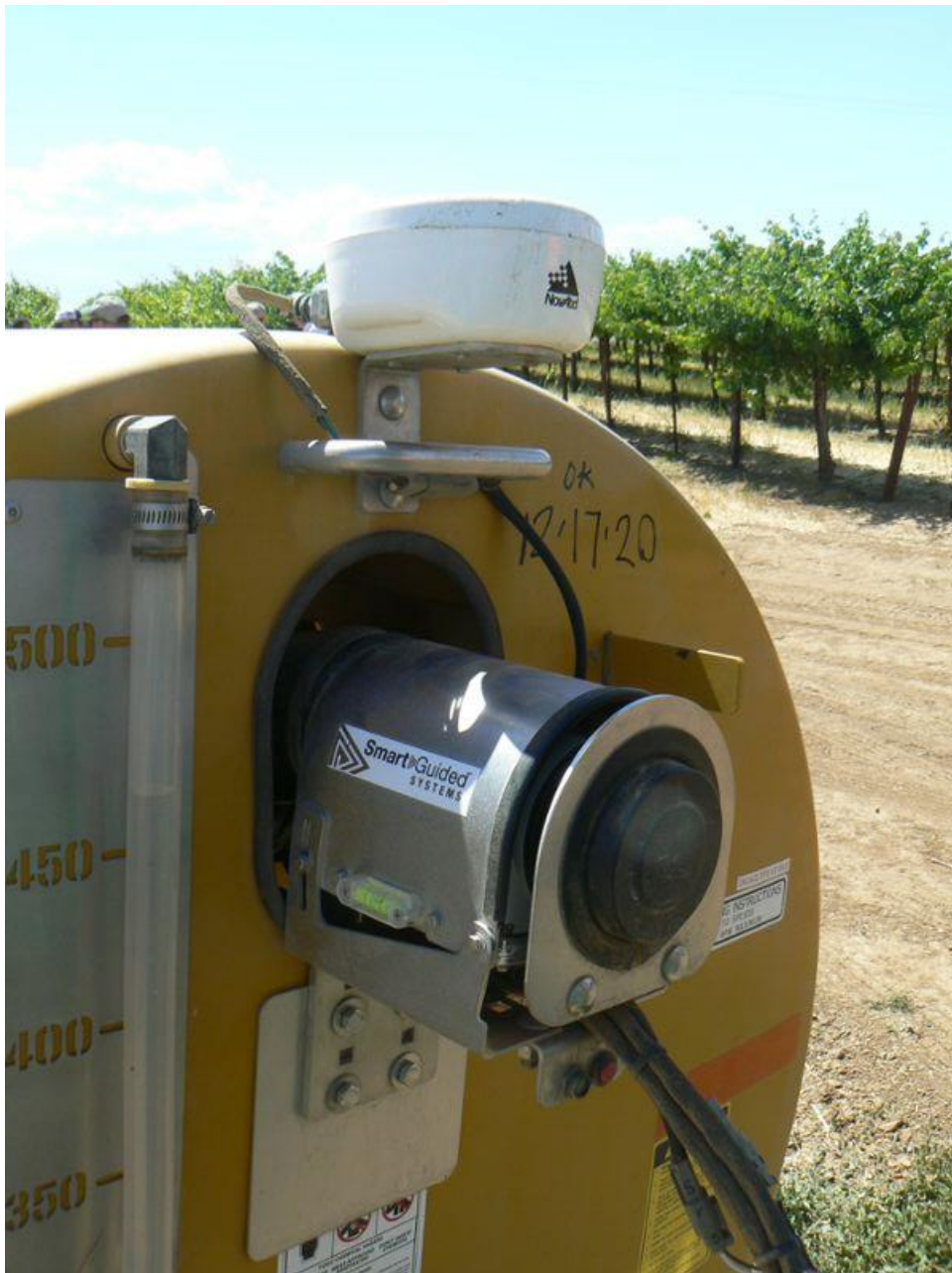
Smart Guided-spuitsysteem LiDAR-scaneenheid gemonteerd op een luchtstraalspuit voor wijngaardproeven. Trinchero Family Estates in Lodi. Foto: Ted Rieger
