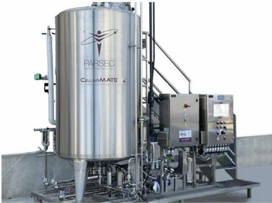
FIGUUR 4 Parsec SRL CellarMate gstrehydrator en expansiesysteem. Dit is een voorbeeld van een van de grotere systemen. De systeemafmetingen worden bepaald op basis van de specificaties van de wijnmakerij.
