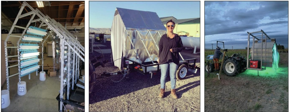
FIGUUR 1 UV-C-prototypes met 24 UV-C-lampen. Prototype 1 werd getrokken door een aanhanger (links en in het midden met Dr. Alexa McDaniel) en prototype 2 werd gemonteerd met een driepuntskoppeling. De combinatie van het ontwerp van de lichtbundel en de b
